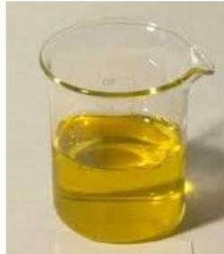
600 mL de la mezcla diésel/biodiesel correspondiente
